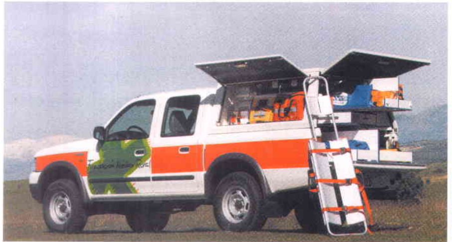
Vehículo de Intervención Rápida (VIR) 4x4, equipado con medios técnicos que permiten la estabilización del paciente, y con dispositivos de localización y de transmisión de datos.
